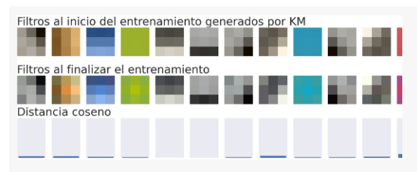
Figura X. Los filtros inicializados mediante el método propuesto requieren pocos cambios durante el entrenamiento.
