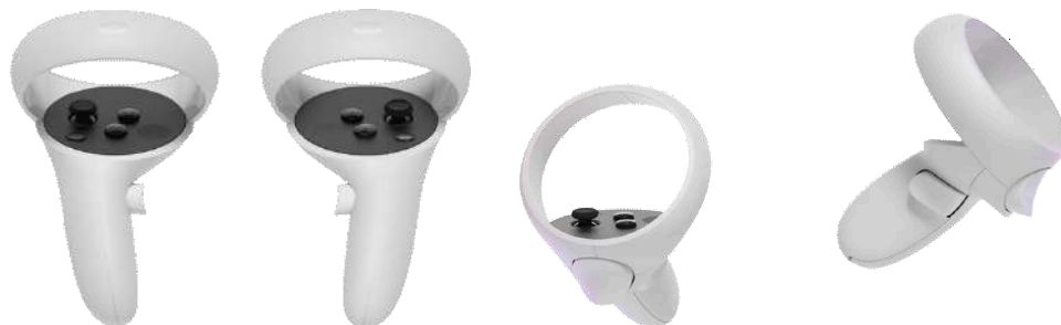
Figura 2.2 - Vista frontal, lateral y trasera de los controles del Meta Quest 2
