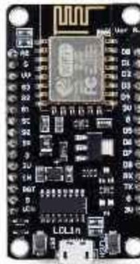
**Figura 25. Captura de Nodemcu Esp32**
