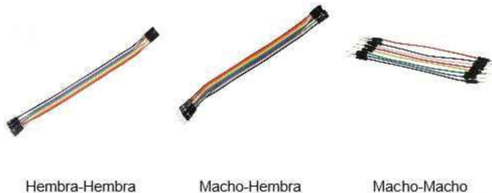
**Figura 31. Ejemplos de cables dupont**
