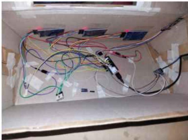
**Figura 51: Conexiones internas de la segunda versión del Tren Universitario!**
