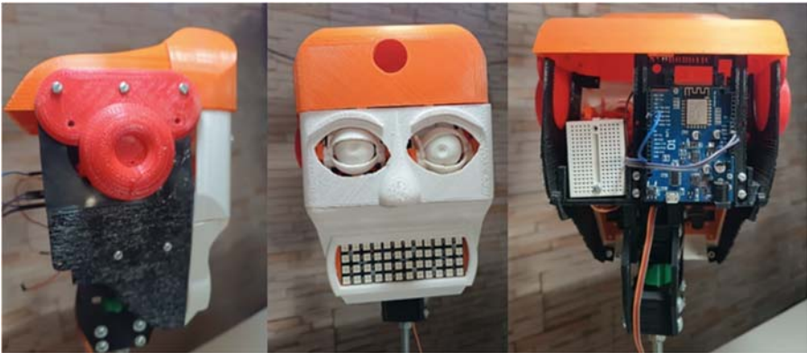
Fig. 11. Cabeza robot terminada y vista del controlador IoT.
