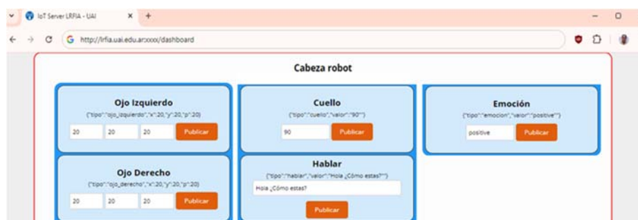
Fig 12. Frontend control de cabeza robot
