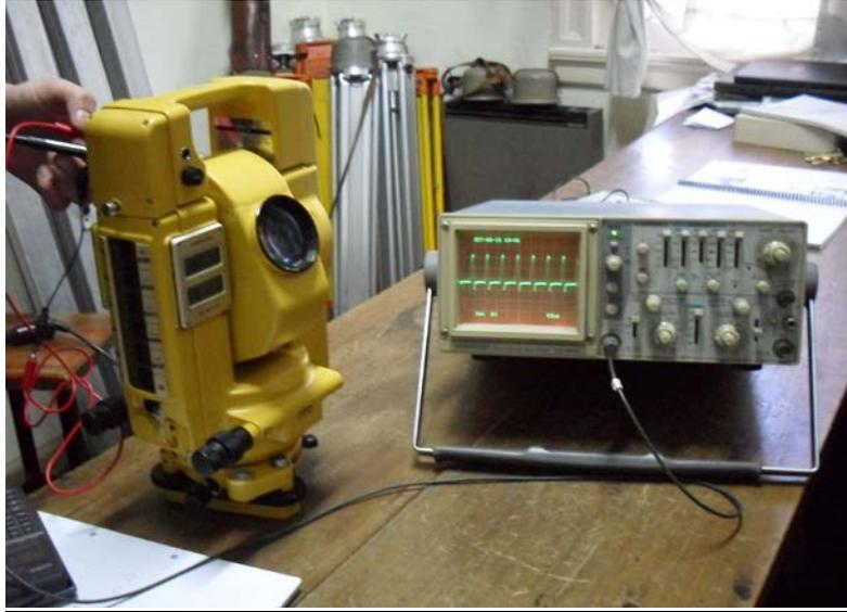
Posteriormente se midió la frecuencia de referencia de la estación TOPCON ET1 con un contador universal de pulsos HP 5328 A (Hewlett Packard), con una resolución de 1Hz. Se midió en el mismo punto que con el osciloscopio y en las mismas condiciones.
