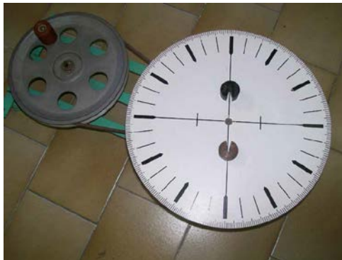
FIGURA 3 DISPOSITIVO EMPLEADO EN LA EXPERIENCIA 2. LOS CUERPOS SE POSICIONAN A LA MISMA DISTANCIA DEL CENTRO DE LA PLATAFORMA.
