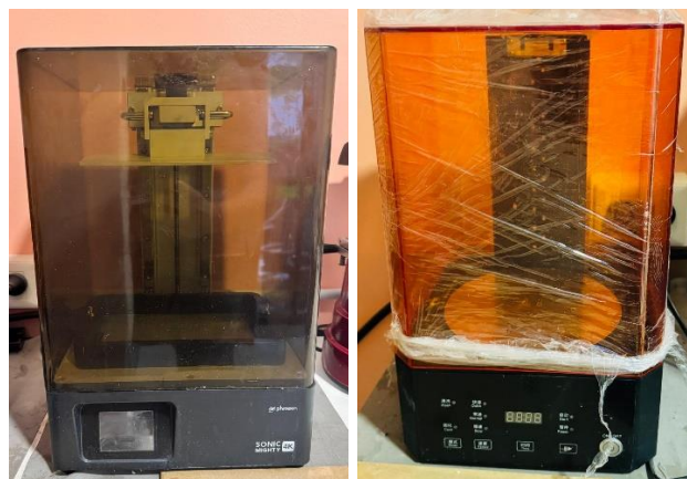
Imagen 5. A- Impresora Phrozen Mighty- B- Curadora marca Crealty.
