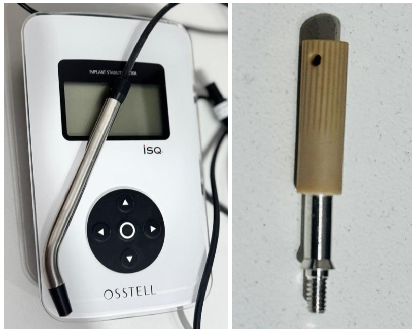
Imagen 8.a- Medidor de estabilidad marca Osstell- b. Smartpeg
