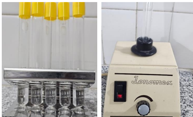
Imagen 19. Tubos de ensayo con agua destilada. Agitador tipo vórtex marca Ionomex
