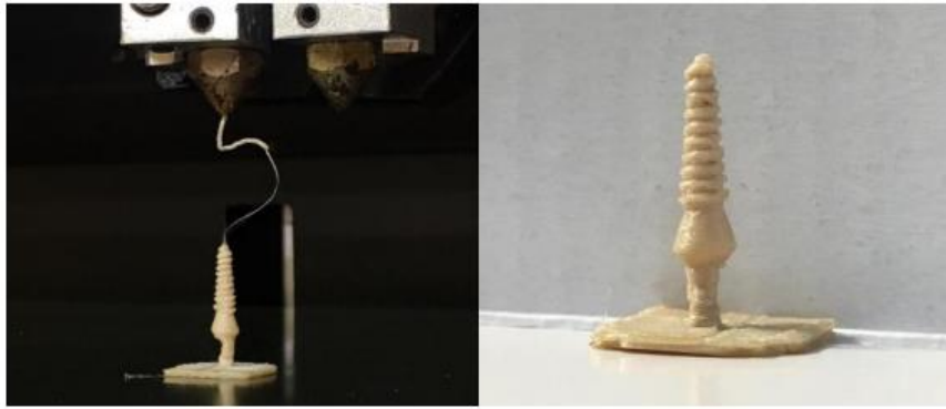
Imagen 3. Proceso de impresión de modelo de implante 3D.
