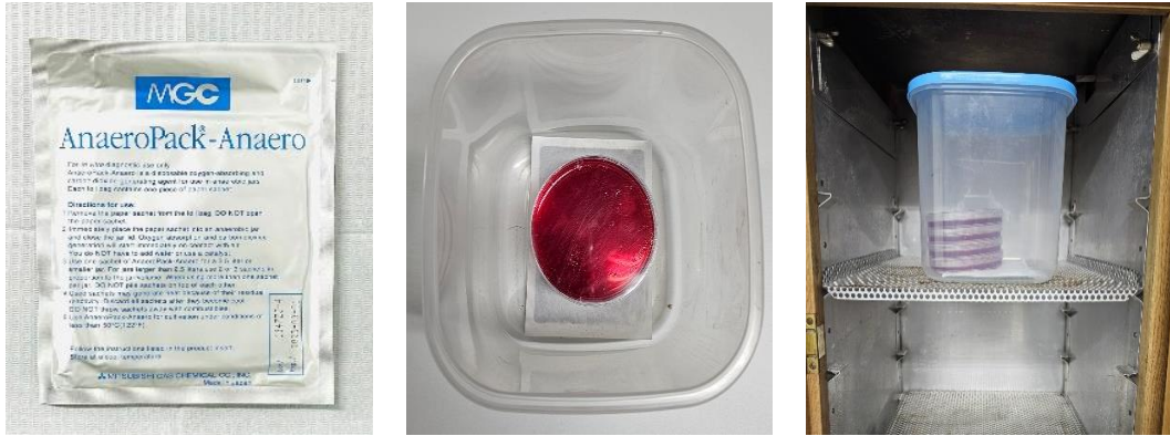
Imagen 17. De izquierda a derecha la secuencia fotográfica muestra: Kit de anaerobiosis, recipiente contenedor, Estufa de cultivo.
