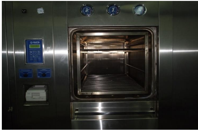
Imagen 5.1. Modelo 2 de Autoclave por presión de vapor marca FAETA.
