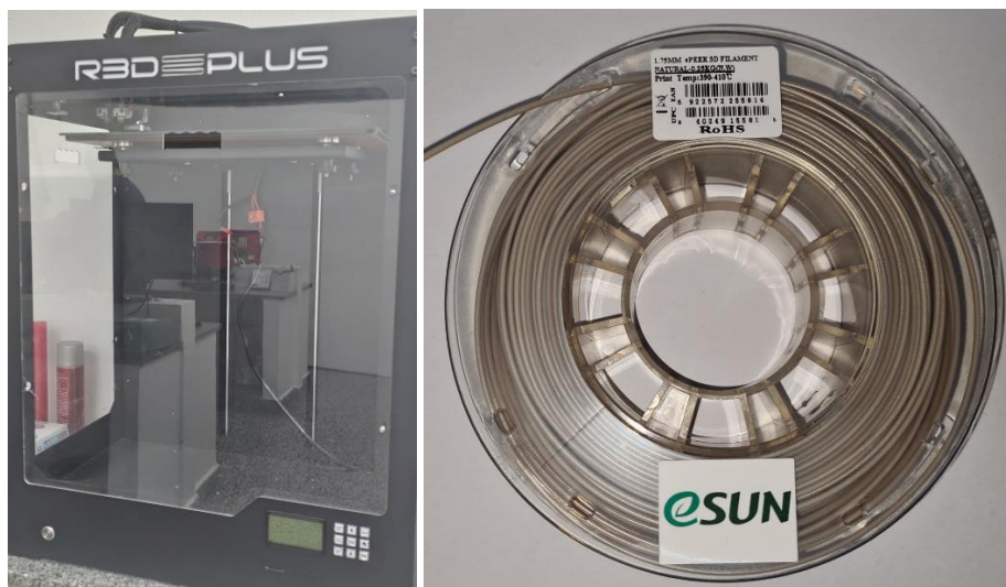
Imagen 2. De izquierda a derecha se aprecia: Impresora 3D marca RBD plus y filamento de Peek e-sun
