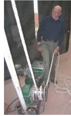
Figura 14: con aparejo simple y con una vuelta de soga en el reenvío
