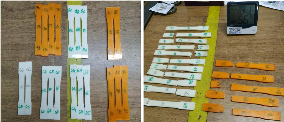
Fig. 5 – Probetas antes y después del ensayo a tracción
