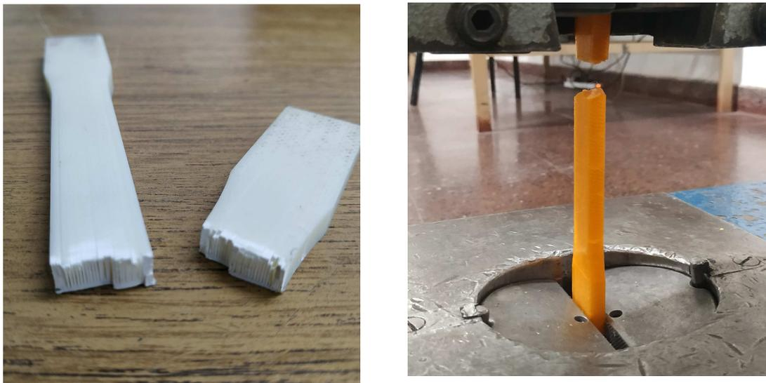
Fig. 6 – Forma de fractura de probetas. Izquierda ABS y derecha PETg
