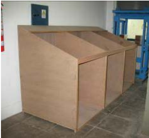
Foto 4 - Aspecto del Contenedor compartimentado en su etapa de construcción
