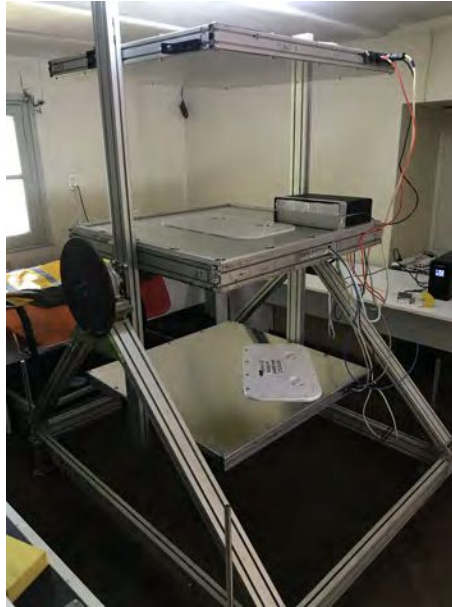
Figura 7.3: Detector de muones instalado en la FCAG-UNLP para realizar mediciones de calibración.
