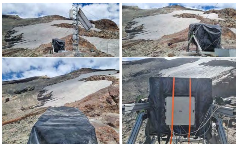
Figura 7.8: Fotos del detector de muones instalado en el sitio elegido, orientado hacia el flanco este del volcán Copahue.
