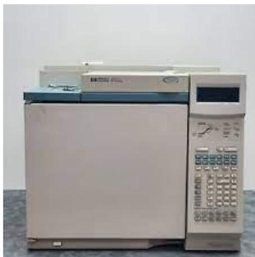
**Figuras 4.6. Cromatógrafo gaseoso HP 6890**
