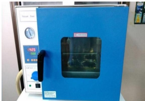
**Figura 2.12. Estufa de vacío ICSA Modelo DZF-6030A**
