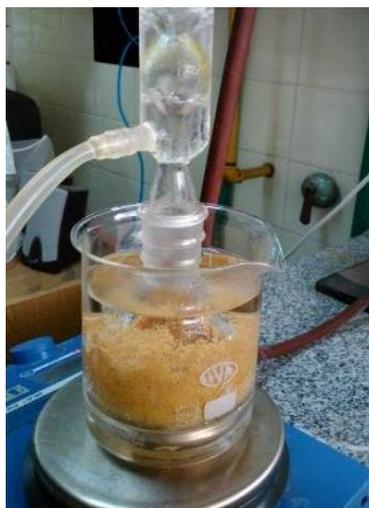
**Figura 4.24. Proceso de extracción de PHA por reflujo**
