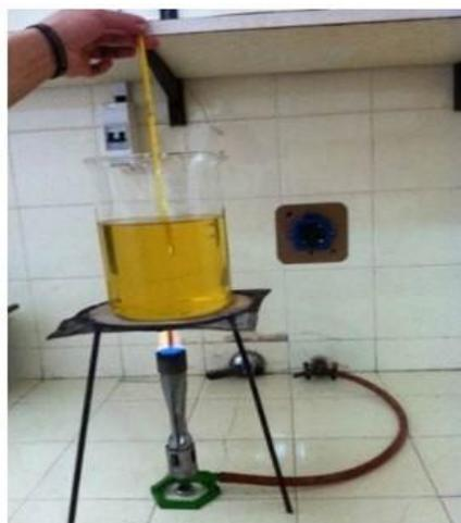
**Figura 4.9. Proceso de eliminación de la humedad del aceite usado**
