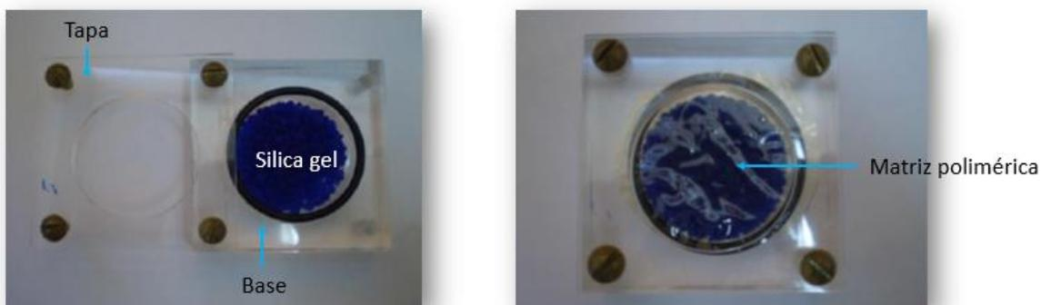
**Figura 5.5. Celda de permeabilidad utilizada para evaluar las propiedades de barrera al vapor de agua**
