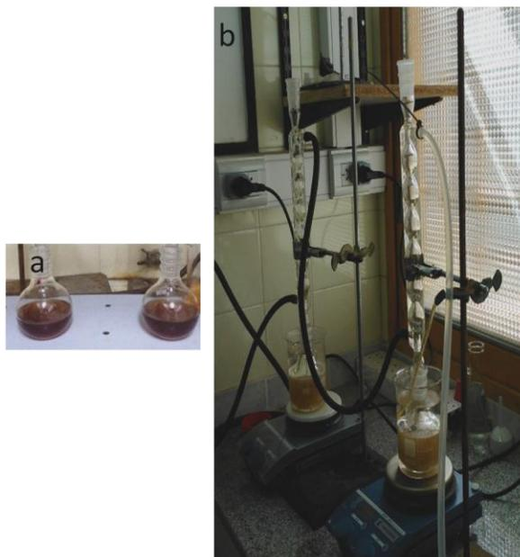
**Figura 4.10. Esterificación ácida. a) preparación de la muestra. b) proceso de reacción.**
