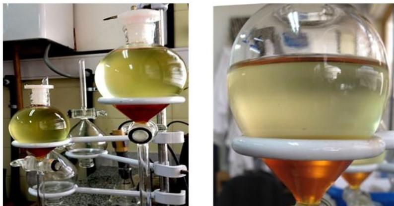
Figura 4.16. Separación de fases de la catálisis básica.
