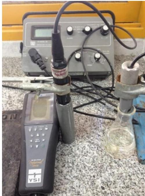
**Figura 2.7. Electrodo de oxígeno polarimétrico YSI Modelo 58**
