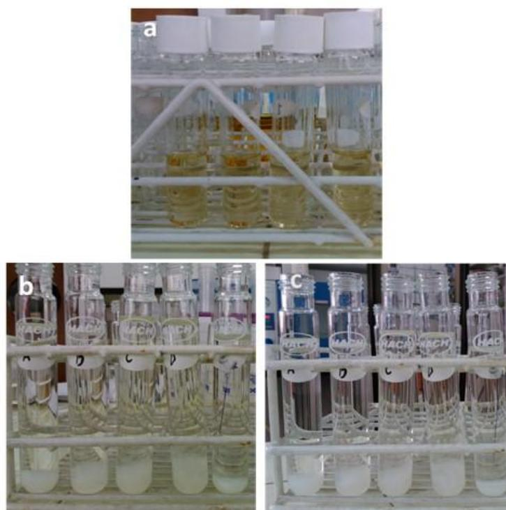
**Figura 3.16. a) Solución de cloroformo libre de restos celulares; b) PHA precipitado con alcohol; c) PHA purificado**
