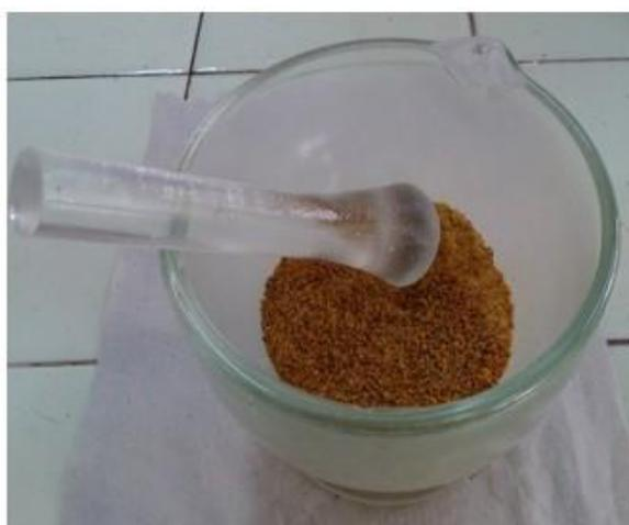
**Figura 3.13. Biomasa luego del proceso de tritución**
