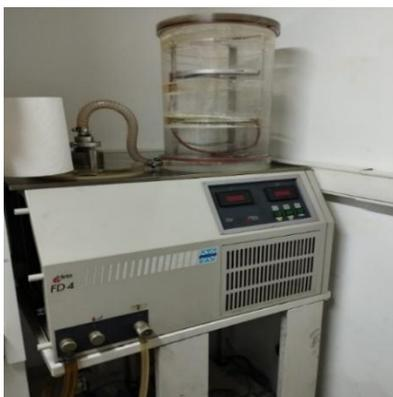
Figura 2.13. Liofilizador Heto-Lab FD4
