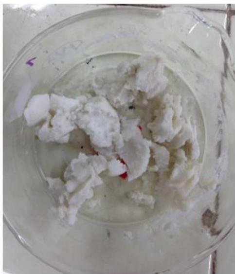
**Figura 3.17 PHA húmedo preparado para el secado**
