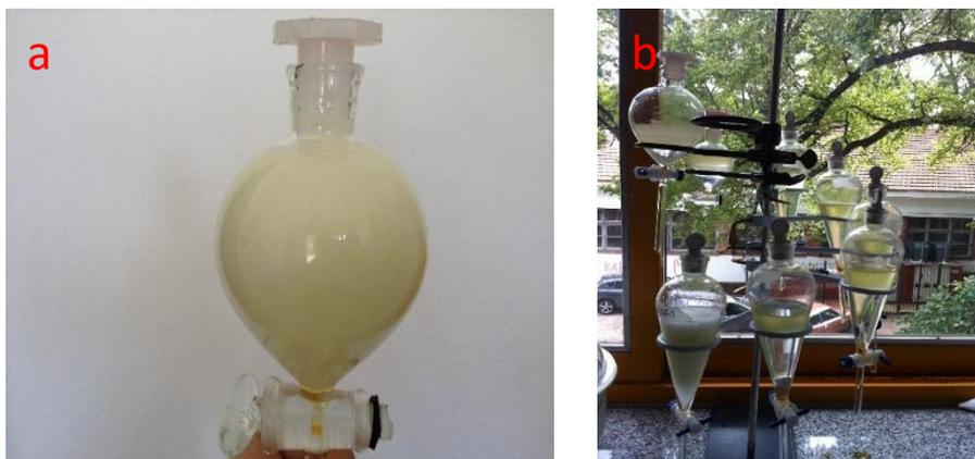
Figura 4.17. Purificación del biodiesel. Catálisis básica. a) biodiesel emulsionado, b) separación del biodiesel y el agua de lavado.
