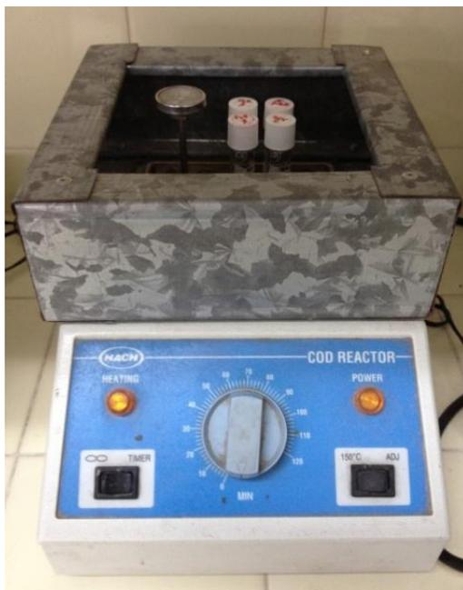
**Figura 2.4. Termo-reactor HACH**
