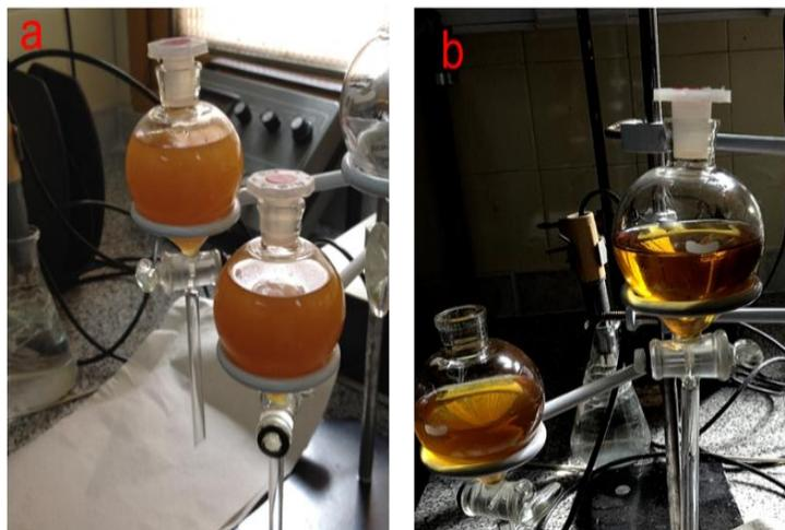
**Figura 4.14. Purificación del biodiesel producido en dos etapas: catálisis ácida y básica. a) biodiesel emulsionado, b) separación del biodiesel y el agua de lavado**
