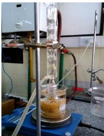
Figura 2.14. Proceso de extracción de PHA por Reflujo
