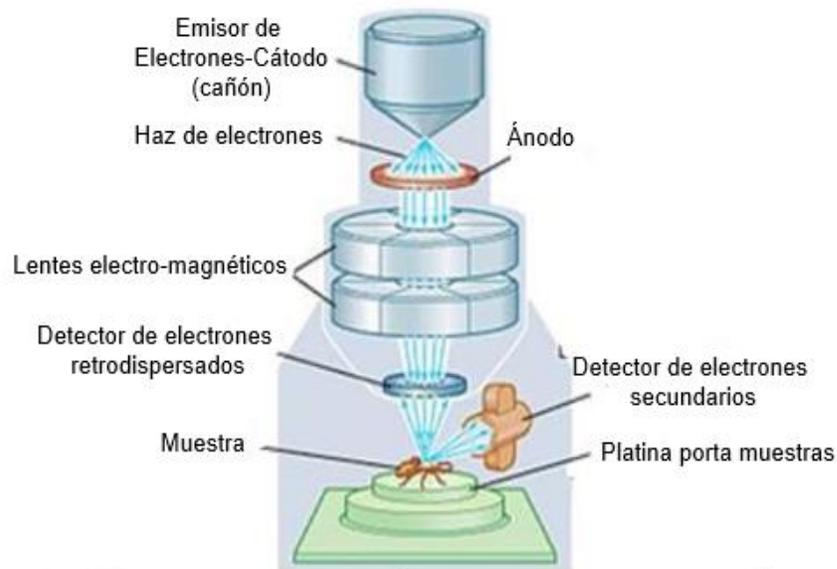
**Figura 5.7. Funcionamiento de un microscopio electrónico de barrido**
