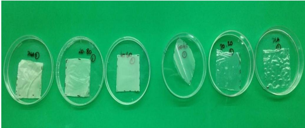
**Figura 5.8. Películas individuales y compuestas antes de ser sometidas a las pruebas de biodesintegración**
