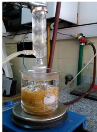
Figura 3.15 Proceso de extracción de PHA por reflujo
