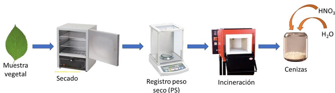
**Figura 2.13.** Esquema de la preparación de la muestra.
