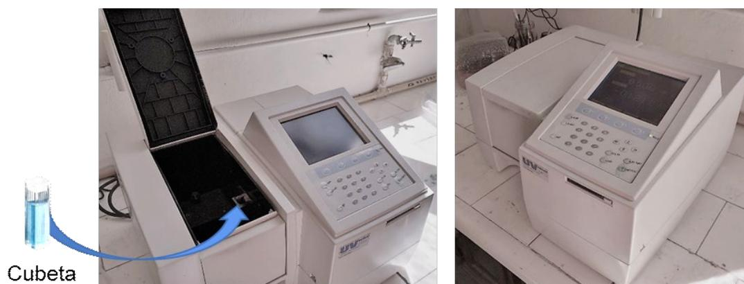
**Figura 2.9.** Fotografías de un espectrofotómetro UV-visible Shimadzu-UV mini-1240
