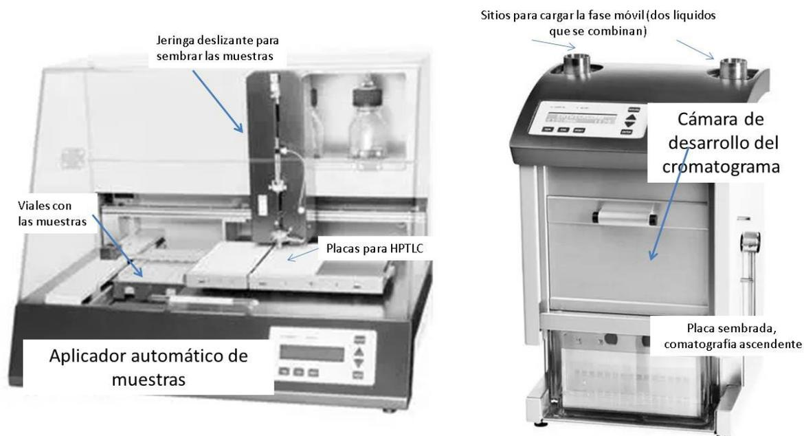
Figura 3.4. Equipo básico para la realización de una cromatografía HPTLC
