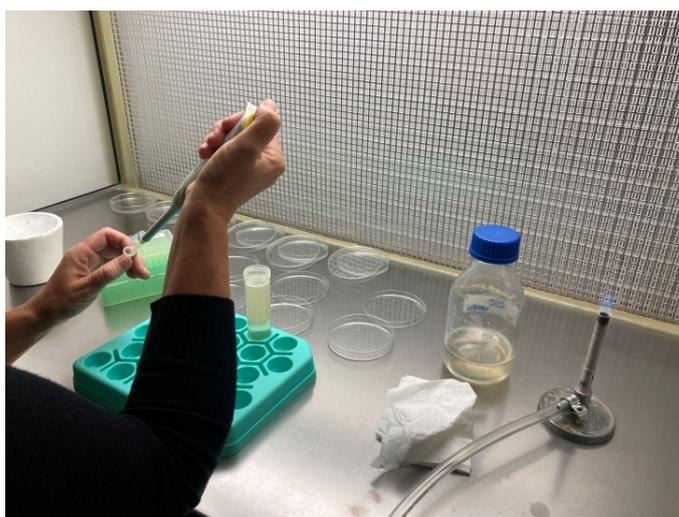
**Figura 5.5.** Cabina de flujo laminar.
