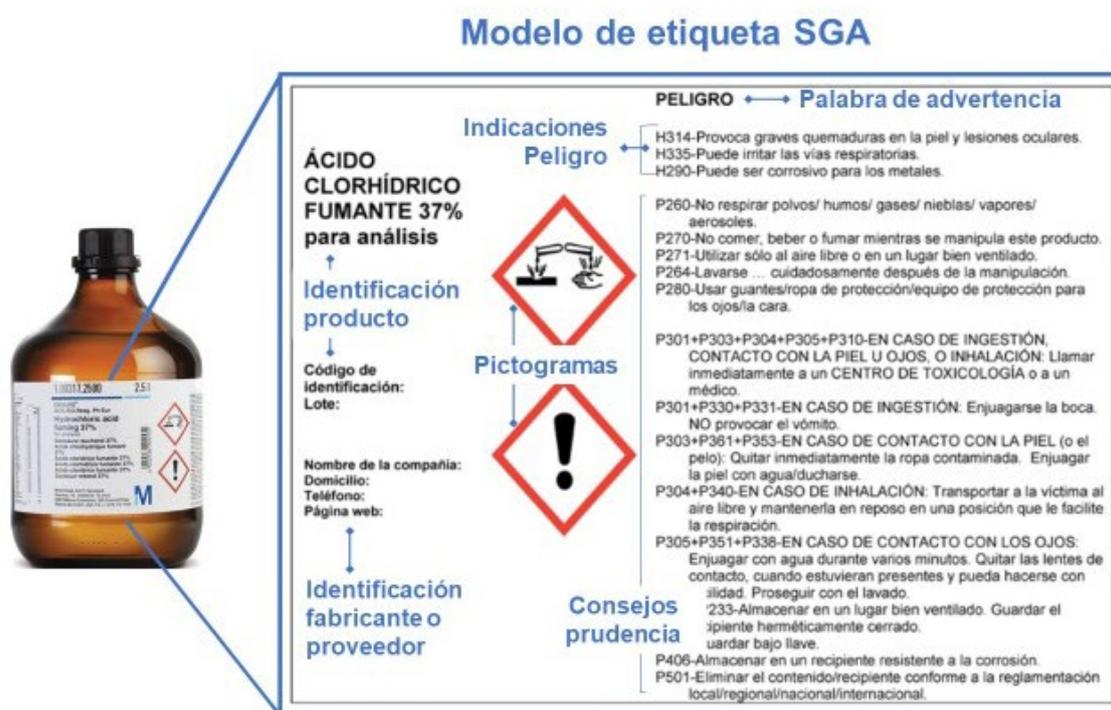
Figura 1.2. Modelo de etiqueta SGA para el ácido clorhídrico (37 % m/m)
