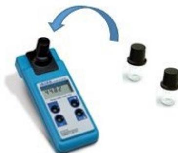
**Figura 2.19.** Imagen de Nefelómetro portátil C-102 HANNA Instruments y sus cubetas. La flecha indica la cavidad donde se debe ubicar la cubeta con la solución a medir.
