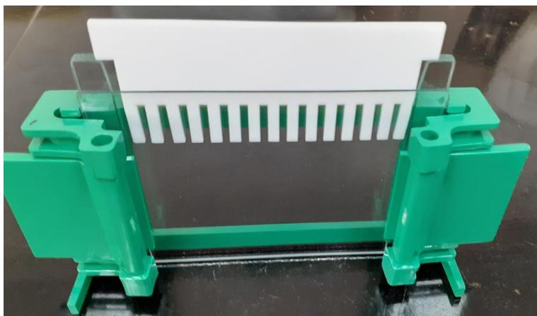
**Figura 4.4.** Molde para la preparación del gel.
