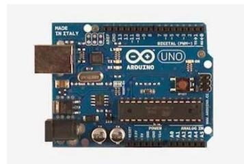
Fig. 2: Placa Arduino UNO
