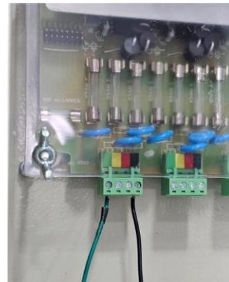
Fig. 6: Cable verde positivo y cable negro negativo conectados a la controladora.
