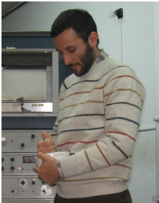
Figura 1.3- Proceso de molienda en mortero de porcelana.
