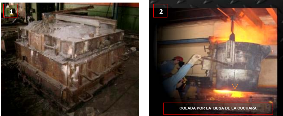
FIGURA 1 - MOLDE DE UN CAJA REALIZADO EN LINO CURE. FIGURA 2 - COLADA DE LA ALEACION EN CADA MOLDE
