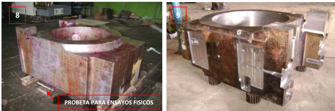
FIGURAS 6 A 9 - MECANIZADO GRUESO O DESBASTE DE LAS CAJAS PORTA COJINETES
