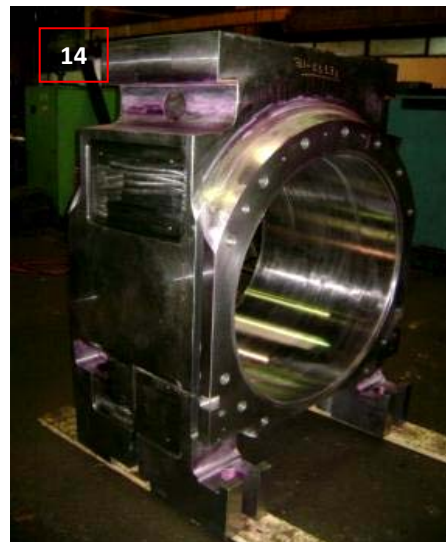
FIGURAS 13 Y 14 - CAJAS PORTA COJINETES EN SUS DIMENSIONES FINALES
