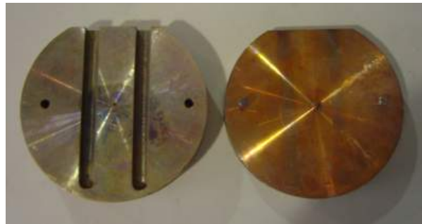
Figura 2: Fotografía del molde de cobre diseñado y utilizado para efectuar microestructuras modificadas
