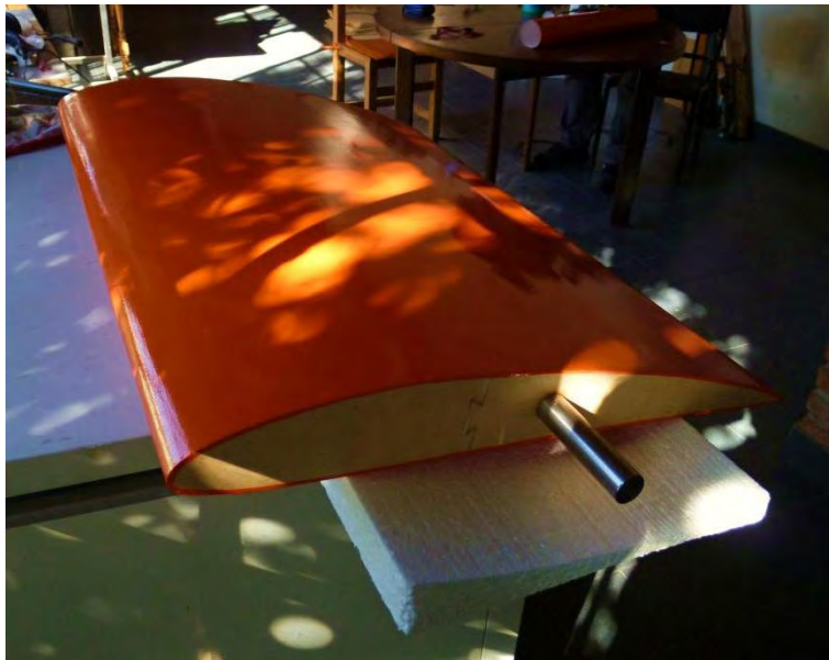
Figura 3.7: Modelo de ala con mini-flap Gurney móvil finalizado.
