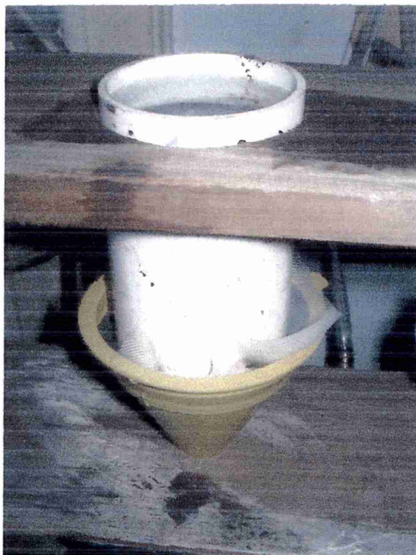
Figura 5.4: Cilindro utilizado para la determinación de la conductividad hidráulica saturada
