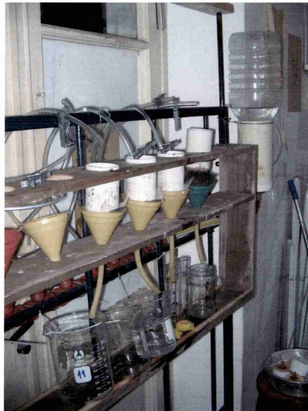
Figura 5.3: Dispositivo Utilizado para la determinación de conductividad hidráulica saturada en laboratorio
