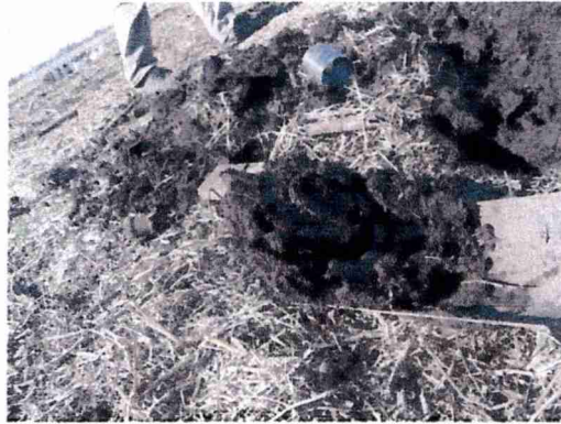
Figura 5.5: Extracción de cilindro para densidad aparente
