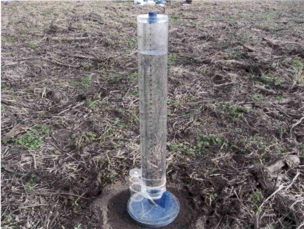
Figura 5.2: Infiltrómetro en el campo
