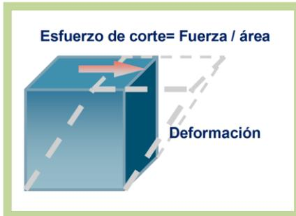
**Figura 2:** Esquema que muestra la deformación sufrida por un material cuando el mismo es sometido a un esfuerzo tangencial.
