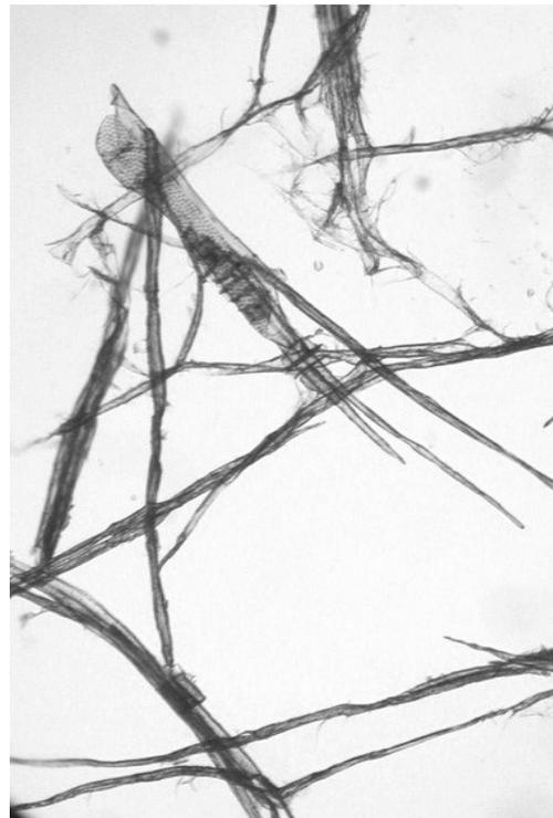
Foto IV. 11. Fracción R30 con fibras enteras con fibrilación externa
