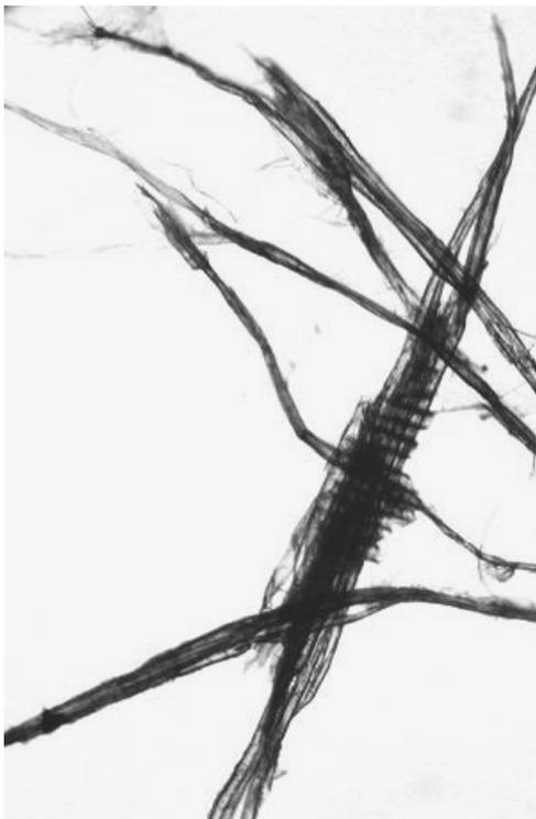
Foto IV. 10. Fracción R30 con minihaces y fibras enteras con extremos escobados
