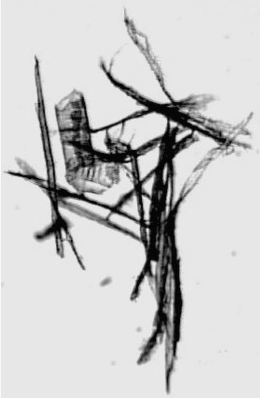
Fig. IV.14. Fracción R100 con fibras cortadas, cintas de pared y vasos enteros
