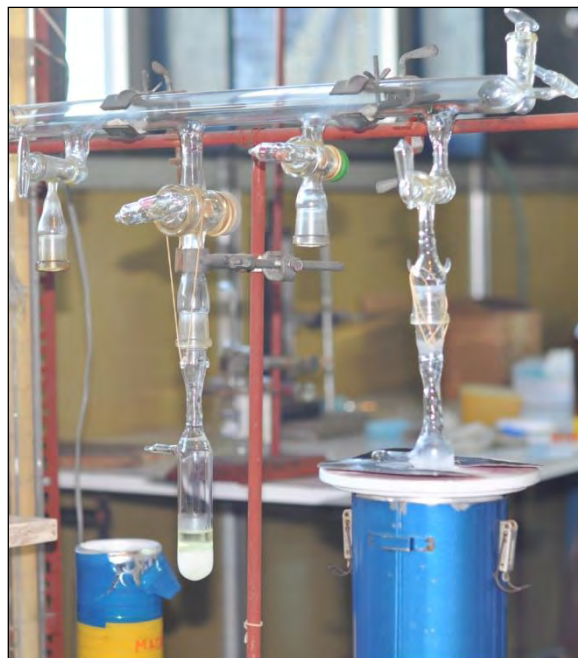
Figura 2.3.1.1. Línea de vacío utilizada para el desgasado y preparación de la muestra
