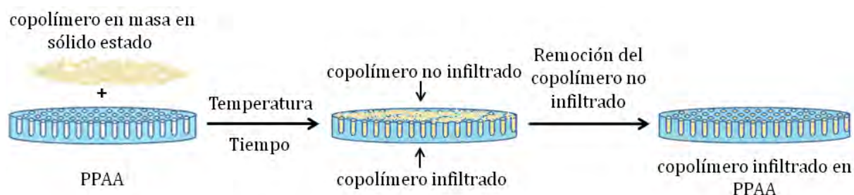
Figura 2.4.2. Representación esquemática del procedimiento de infiltración.
