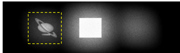
Figura 4.11. Intensidad del plano de salida para un sistema de encriptación JTC
