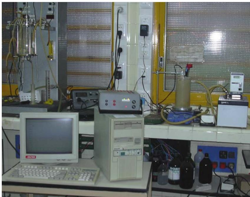
Figura 3.2. Respirómetro abierto
