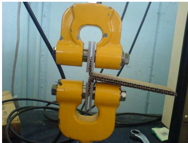
Figura 7.3: Ilustración del ensayo de Pelado en T.
