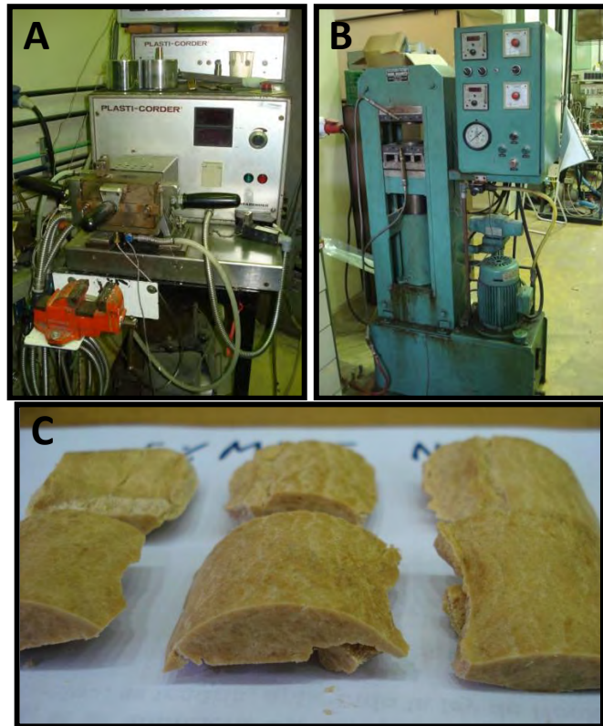
Figura 3.1: Las fotos muestran los equipos utilizados en el proceso de obtención de películas nanocompuestas por termocompresión, siendo: A- Mezcladora Brabender Plasti-Corder y B- Prensa hidráulica de moldeado, (C) muestra las fracciones obtenidas de la mezcladora a modo de ejemplo.
