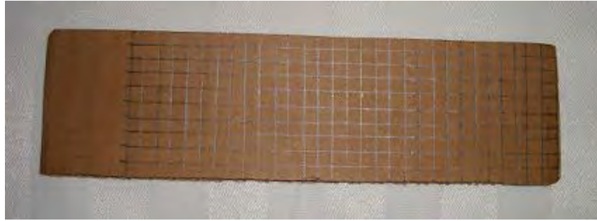
Figura 7.2: Probeta de cartón utilizada para los ensayos de Pelado en T
