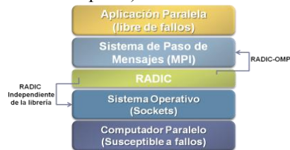
Figura 1. Capas de RADIC que proveen tolerancia a fallos de manera transparente a las aplicaciones
