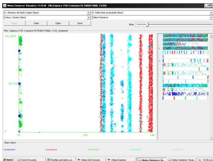
**Figura 4** Visualización usando EM sobre el Atributo Longitud, Protocol, Delta Time Acumulado y Nodo Origen muestra 17:30 hs
