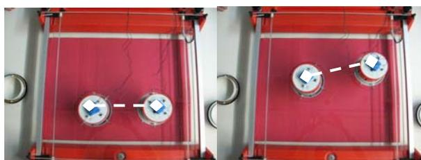
Figura 2. Ejemplo de choque elástico
