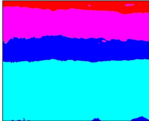
Figura 6. Imagen segmentada resultante: en rojo se observa la zona de playa seca, en magenta la zona de playa húmeda, en azul la zona de lavado y en cian la zona de derrame.
