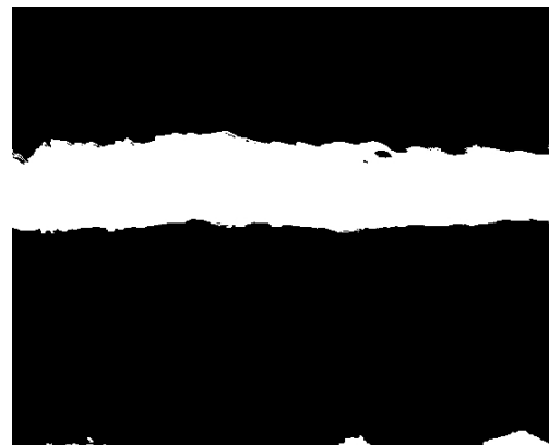
Figura 5. Clasificación de la imagen por valor de umbral de la zona de lavado.
