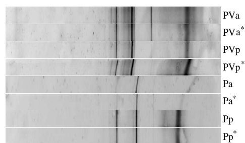
Figura 3.6. Patrón de bandas de DGGE para réplicas independientes de diferentes ensayos de inmovilización. P (Perlita); V (Vermiculita); CV (Carbón Vegetal); PV (Perlas de Vidrio) y EP (Esponja de Poliuretano). a: Células adheridas. p: Células planctónicas. *: réplica.
