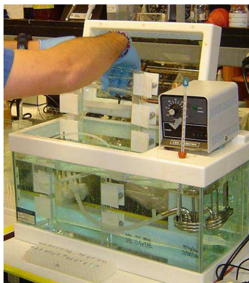
Figura 2.2. Fotografía del equipo de DGGE. A. Cuba de electroforesis; B. Gel; C. Regulador de temperatura; D. Resistencia; E. Termómetro
