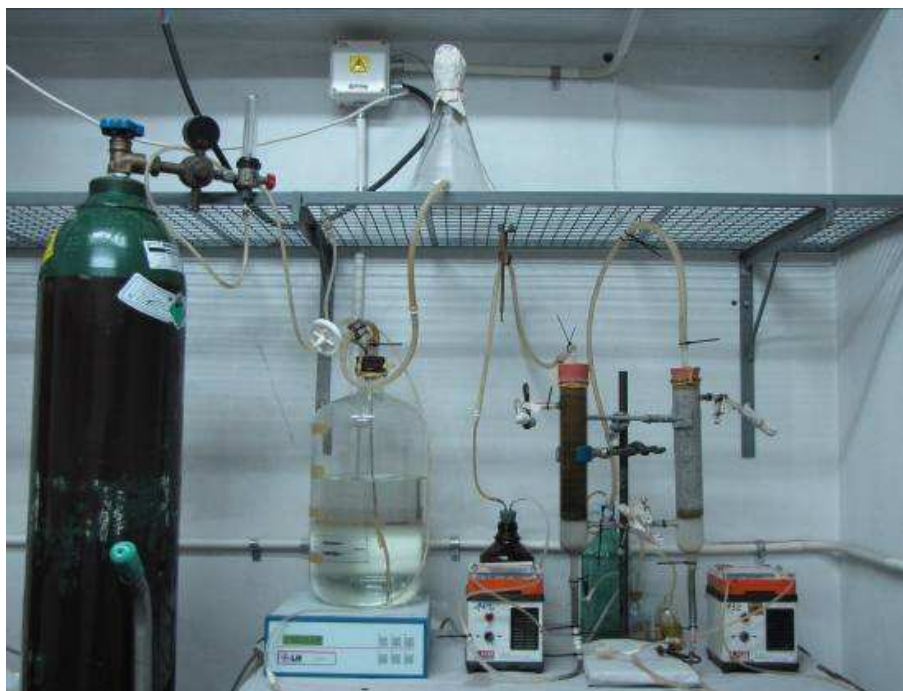
Figura 4.7. Fotografía del sistema de reactor de lecho fijo de flujo ascendente para la EP y P.
