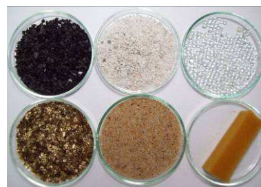
Figura 3.1. Soportes de inmovilización. Carbón Vegetal (CV); Perlita (P); Perlas de Vidrio (PV); Vermiculita (V); Arena (A); y Esponja de Poliuretano (EP).
