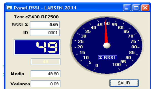
Figura 8 Aplicación en PC empleada para caracterizar la indicación de RSSI
