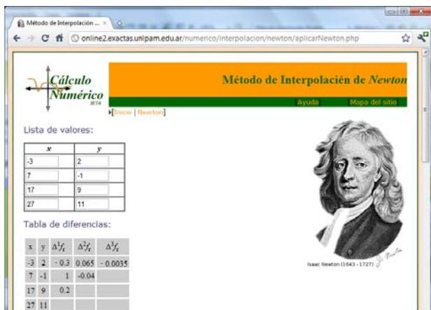
Figura 4. Método de Newton. Tabla de diferencias generada por la aplicación a partir de los valores ingresados.
