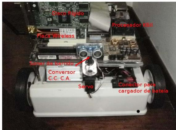
Fig.2 Prototipo con tracción diferencial
