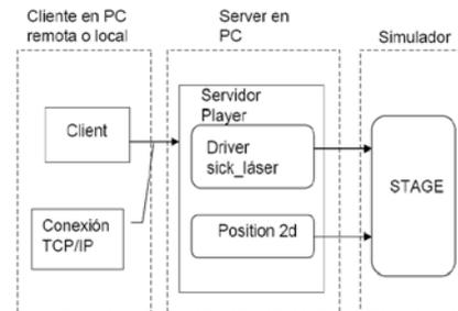
Fig.1 Diagrama en bloques del simulador players/Stage
