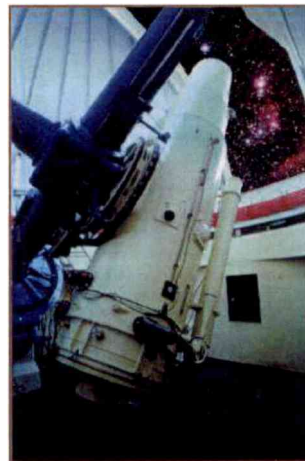
Figura 6.3: Telescopio Curtis Schmidt de CTIO
