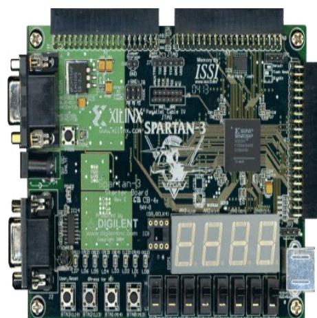
Figura 3. Spartan 3 Starter Board con una FPGA Spartan 3.
