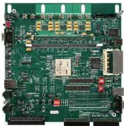
Figura 2. Virtex II Pro Developer System con una FPGA Virtex II Pro.
