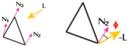
Figure 2: (Izq) Normales y dirección de la Luz. (Der) Ángulo entre la Normal y la dirección hacia la Luz.
