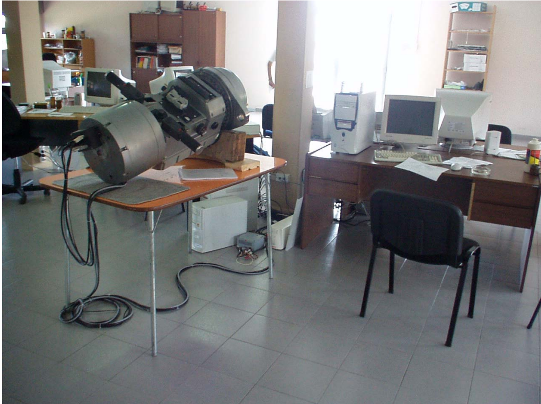
Fig. 2: Hardware del sistema: Unidad de periscopio, lentes, conexiones llevando las 8 señales y computadora encargada de la simulación.
