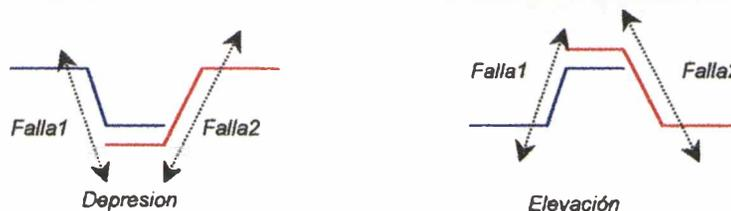
Figura 4.24 Depresión y Elevación formadas por la Falla
