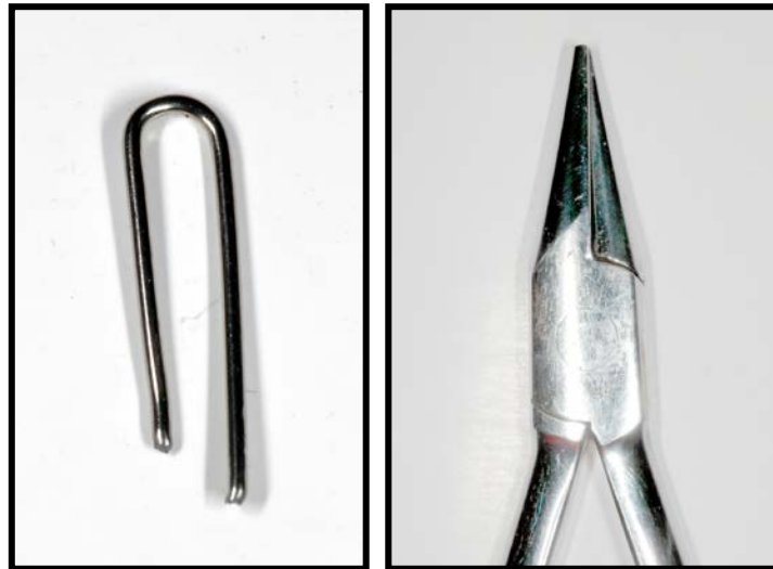
Ilustración 17 Fotografía del alambre de acero inoxidable y pinza utilizada.
