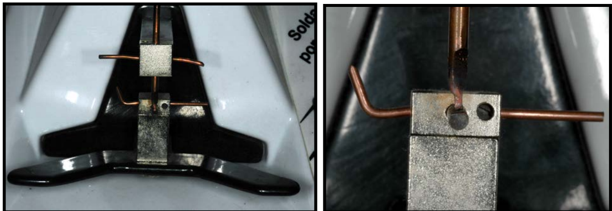
Ilustración 20 Fotografía de los electrodos de la soldadora, adaptados al caso. Fuente primaria.
