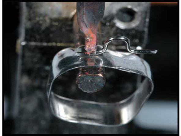
Ilustración 21 Fotografías de la secuencia de soldado del omega a la banda.
