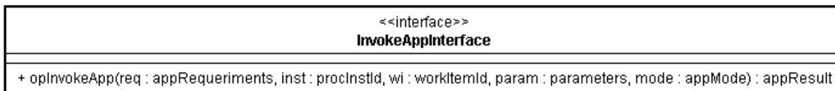
Figura 5: Descripción del elementos interface del servicio web InvokeApplication
