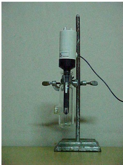
Figura 2.4: Reactor fotoquímico y electrodo utilizados para las mediciones de O_2 .
