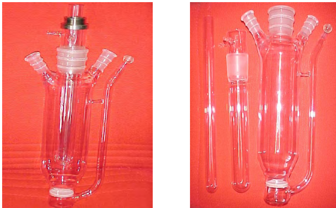
Figura 2.3: Fotorreactor utilizado para los experimentos de fotólisis estacionaria.
