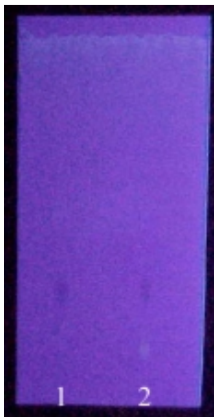
Figura 13.23. Corrida de TLC de solución de ácido fólico (450 \mu\text{M} ) y alcohol furfurílico (10 mM). Solvente de corrida \text{NH}_4\text{Cl} 3,0%(p/v). Calles: 1, solución no irradiada; 2, solución irradiada durante 80 min.
