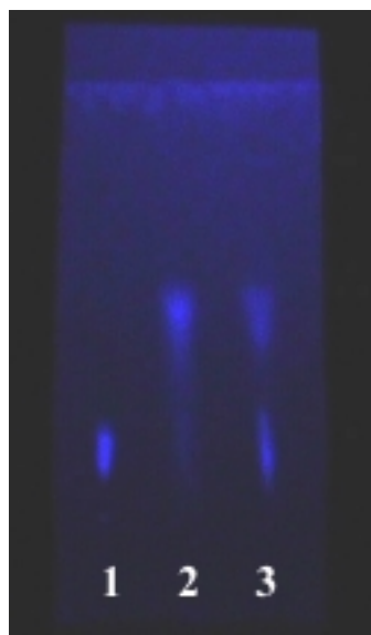
Figura 16.14. Corrida de TLC. Calles: 1, solución patrón de 6-carboxipterina 200 \mu\text{M} ; 2, solución patrón de 6-formilpterina 150 \mu\text{M} ; 3, solución de 6-formilpterina 150 \mu\text{M} (pH= 11,0) irradiada, en ausencia de \text{O}_2 33 min. y luego aireada.
