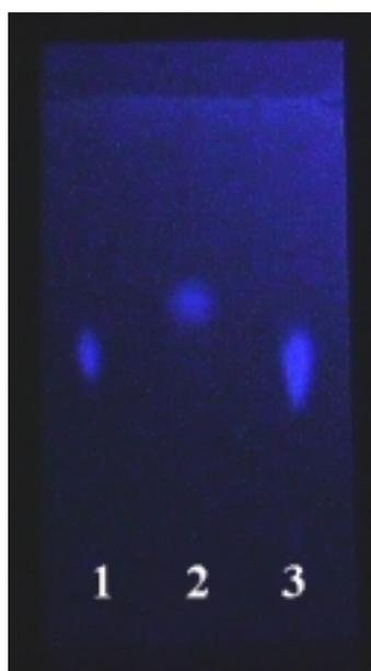
**Figura 17.3.** Corridas de TLC. Calle: 1, solución de 6-carboxipterina 200  $\mu\text{M}$  (pH= 11,0) irradiada 150 min; 2, solución de pterina 100  $\mu\text{M}$ ; 3, solución de 6-carboxipterina 200  $\mu\text{M}$ .
