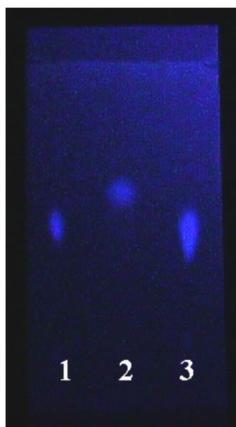
Figura 17.3. Corridas de TLC. Calle: 1, solución de 6-carboxipterina 200 \mu M (pH= 11,0) irradiada 150 min; 2, solución de pterina 100 \mu M; 3, solución de 6-carboxipterina 200 \mu M.
