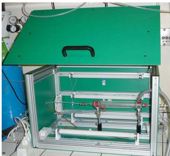
Figura 3-3: Reactor tubular de flujo. Laboratoire d'Application de la Chimie à l'Environnement (LACE), Lyon, Francia.
