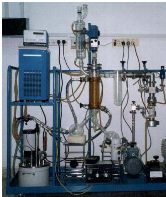
**Figura 4-1:** Equipamiento de destilación molecular
