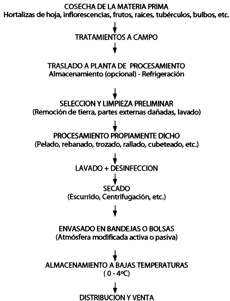
Figura 1. Diagrama de flujo señalando las principales etapas en la producción de hortalizas mínimamente procesadas (Viña, 2001).
